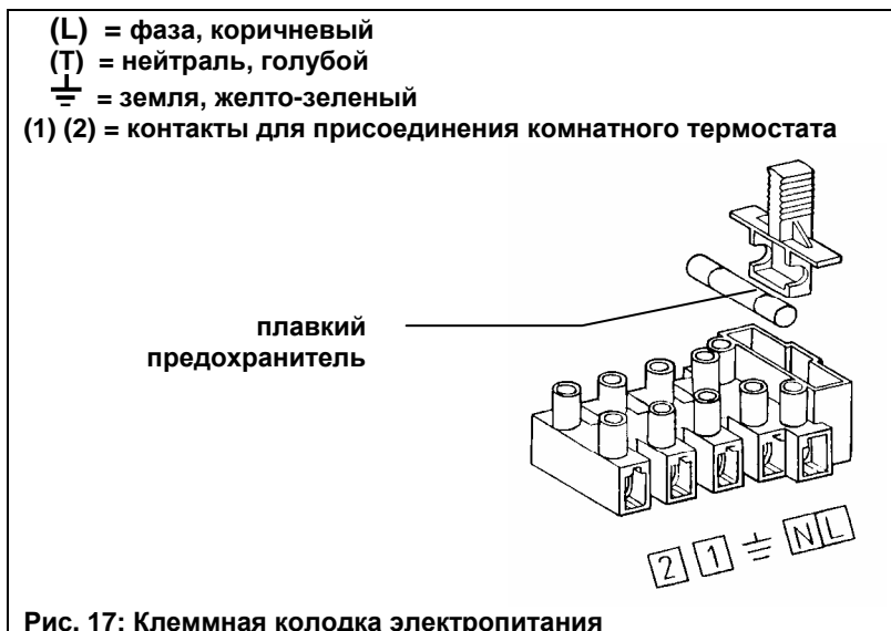
Рис. 17: Клеммная колодка электропитания
